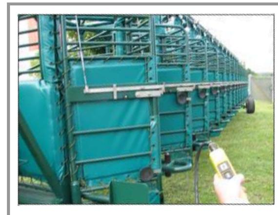
Les ressorts d'ouverture sont intégrés aux châssis de la porte, les rendant ainsi invisibles et protégés des intempéries.
