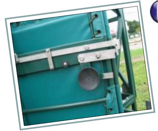
Dans les deux cas, un arbre, des tringleries en inox et une armoire électrique synchronisent l'ouverture des portes avant.
